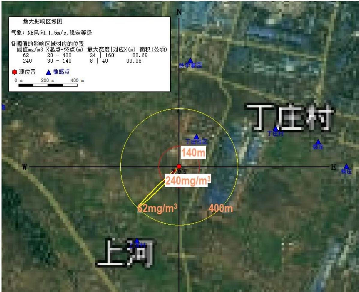
图 1.8-1 硝酸达到不同毒性终点浓度的最大影响区域图（稳定度 F）
