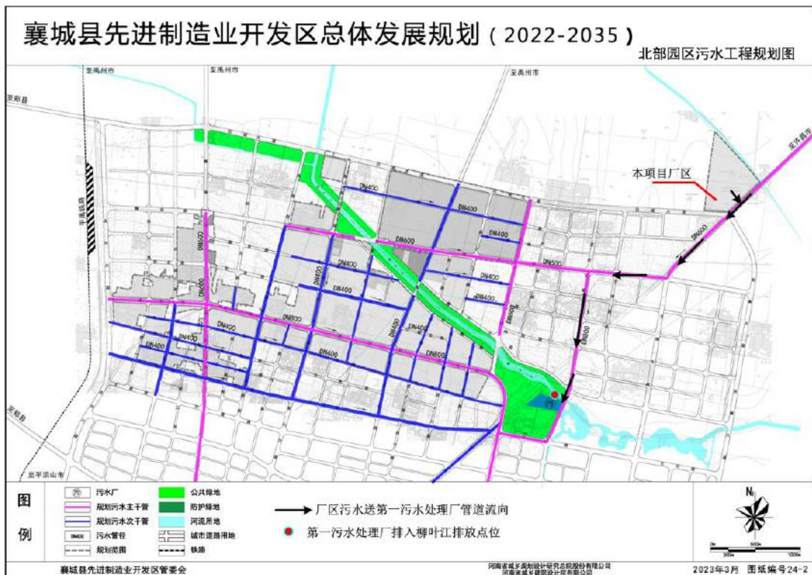
图 6-3 （远期）园区规划的污水收集管网与本项目位置关系示意图
