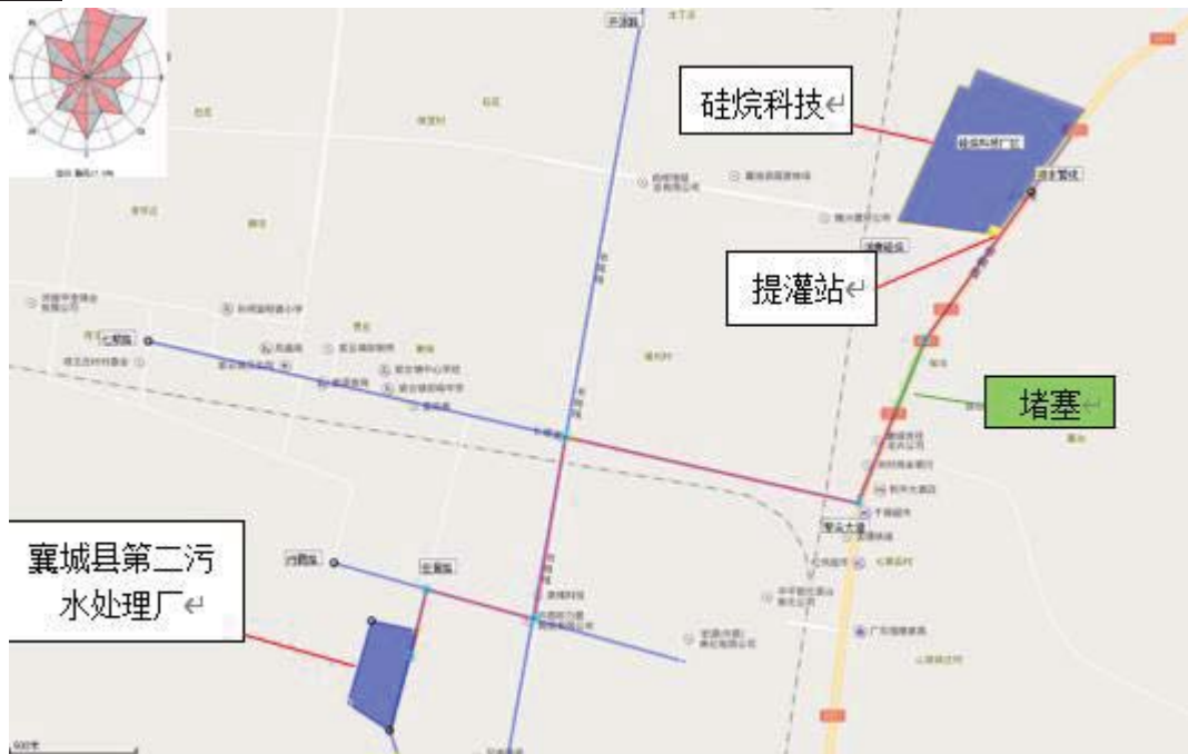
图 5-13 硅烷科技至襄城县第二污水处理厂管道铺设情况
