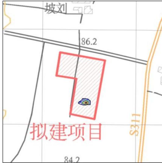
图 6-35 废水处理站调节池渗漏地下水石油类污染含水层预测图-30 年
